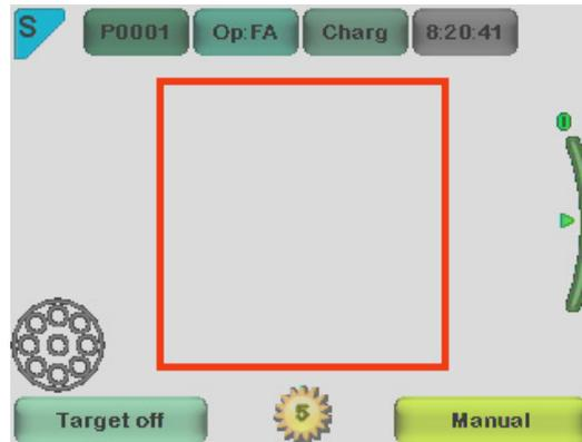
3. Voreingestelltes Anzeigefenster, wenn das FA-Objektiv mit Hilfe des AF-Hilfsmodus (AF Assist mode) aufgesetzt wird. Die Dioptrienskala wird automatisch angepasst. Das Bild kann aufgezeichnet werden, wenn die Verschlussstaste halb gedrückt ist.
