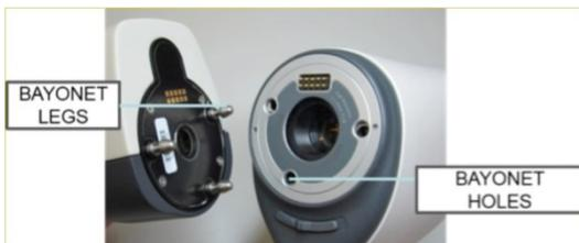
Ein Objektiv wird angebracht, indem es vor den Bajonett-Bereich des Gerätes gebracht wird. Drei Bajonett-Beine werden in die Löcher gesteckt und das Objektiv wird fest in das Gerät gedrückt.
